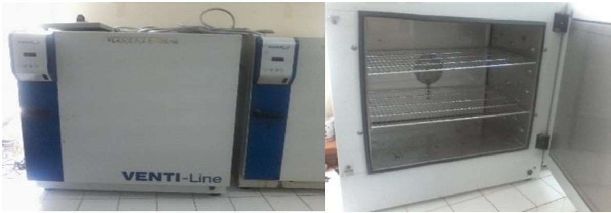
Figure 35 : Etuve pour séchage de type VL 115
