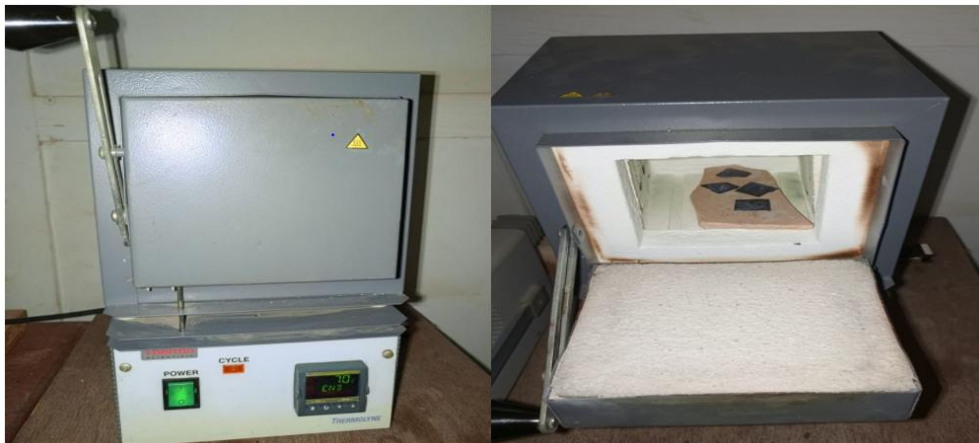
Figure 36 : Four thermolyne pour le recuit des échantillons
