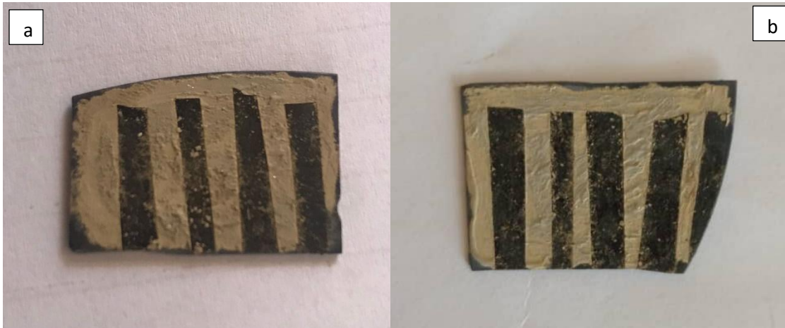
Figure 37 : Echantillons de Si métallisés avec de la laque d'argent, a) Echantillon 1, b) Echantillon 2
