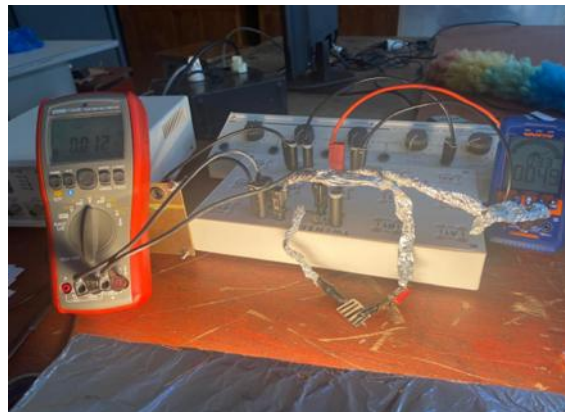
Figure 46 : Banc de caractérisation électrique de la cellule solaire
