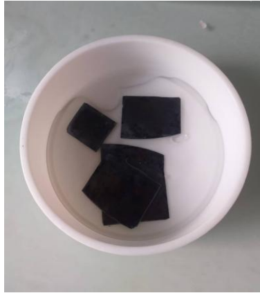
Figure 28 : Elimination totale de la mousse d'argent sur la surface des échantillons.
