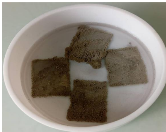
Figure 27 : Dépôt de la mousse d'argent à la surface des échantillons
