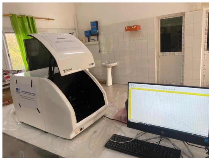
Figure 39 : Spectrofluorimètre SAFAS Xenius XC
